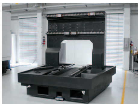
Станина станка из полимерного бетона
