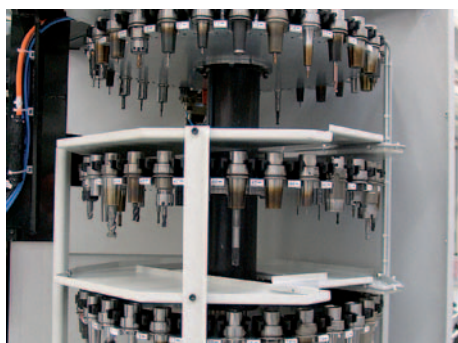
Устройство смены инструментов на 90 позиций
